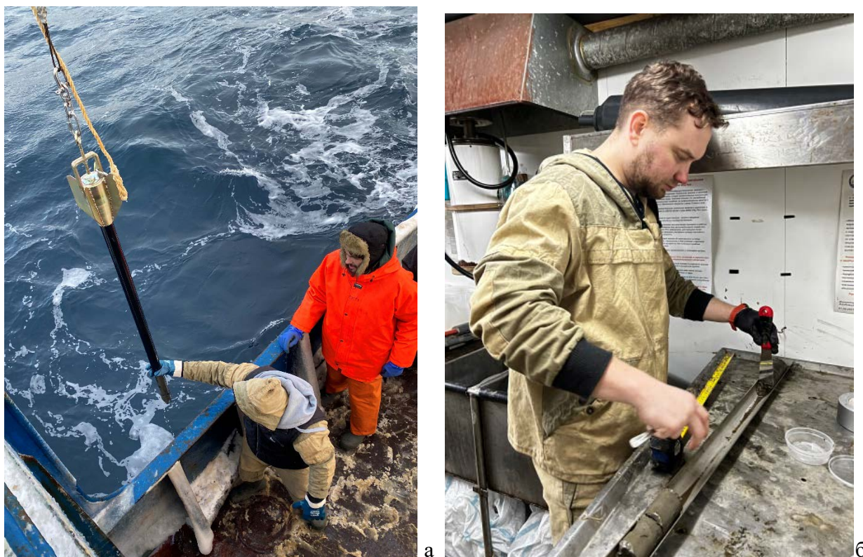
Рис. 7. Отбор проб трубкой ГОИН 2.0 (а) и первичная обработка проб на борту (б) (фото Т.М. Максимовской)
