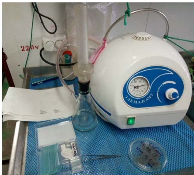
Рис. 5. Вакуумный насос и установка для фильтрования морской воды на определение количественных показателей нанофитопланктона в условиях судовой лаборатории (фото О.П. Калинка)
