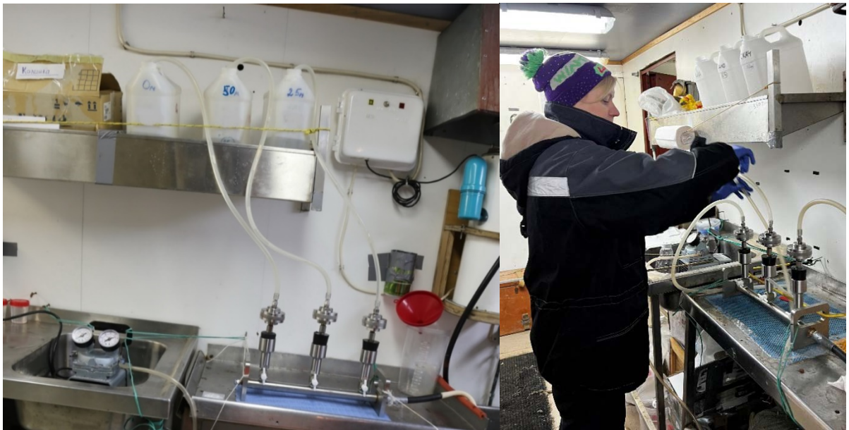
Рис. 4. Вакуумный насос и смонтированная установка для фильтрации морской воды на определение концентрации хлорофилла в условиях судовой лаборатории (фото Т.М. Максимовской)
