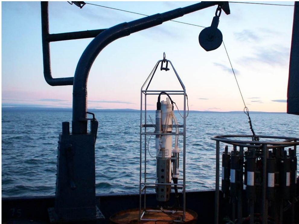
Рис. 3. СТД-зонд SEACAT SBE 19plus (фото М. Громова)
