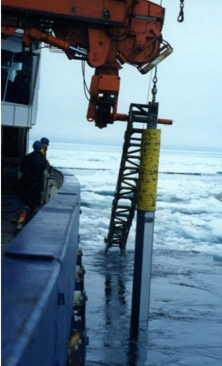
Рис. 2. Отбор донных отложений с коробчатой грунтовой трубкой (KAL; кастенлот)
