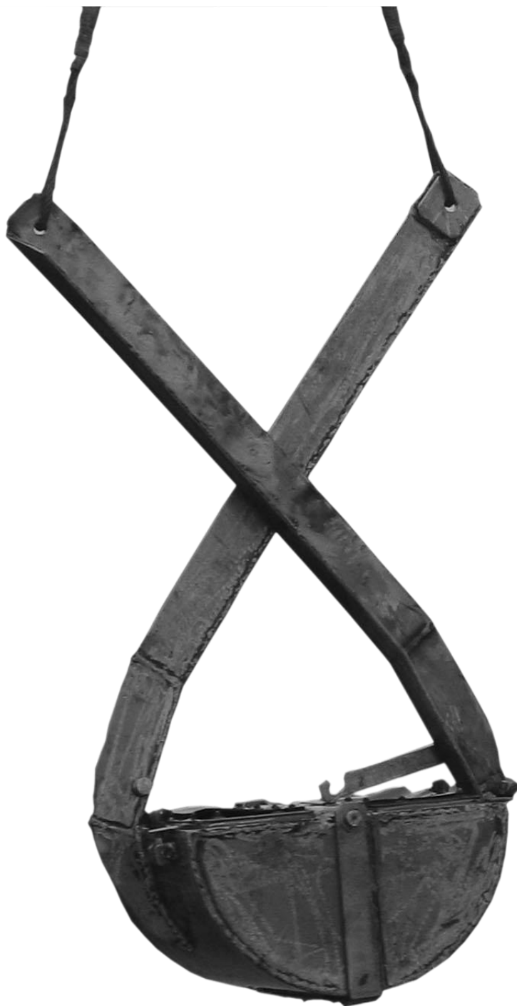
Рис. 9. Дночерпатель конструкции ван-Вина с площадью пробоотбора 0.1 м 2
