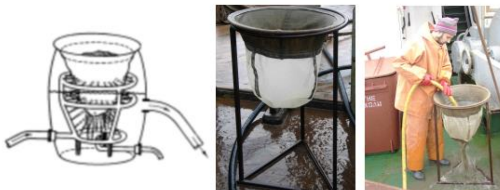
Рис. 8. Промывочный станок конструкции Н.В. Федикова (бочка Федикова) (слева), ее упрощенная модификация конструкции А.В. Сикорского (в центре) и промывка бентосной пробы с ее использованием (справа)
